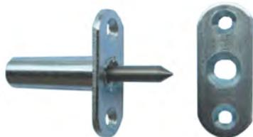
A circa 70° - 80°C il perno fuoriesce stabilizzando l'anta sul telaio di porte e portoni antincendio, il montaggio orizzontale e/o verticale con il perno verso il basso.
